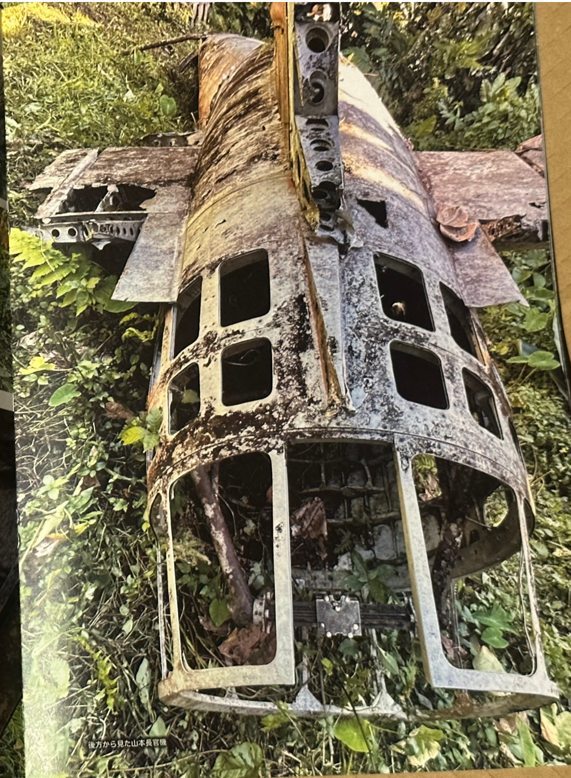
尾部は翼に破損が見られるが胴体部分はほとんど破損していない。(上) 前方から後部を見る。一式陸攻の床は同じ規格の波板パネルになっている。(下)
