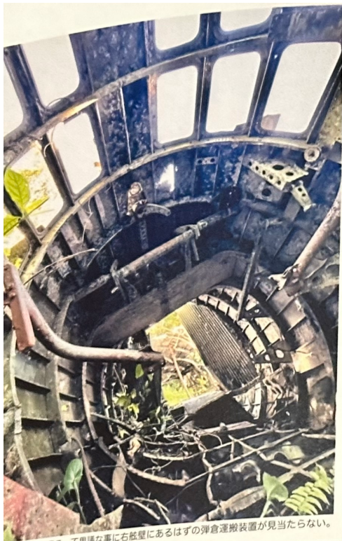
尾部は翼に破損が見られるが胴体部分はほとんど破損していない。(上) 前方から後部を見る。一式陸攻の床は同じ規格の波板パネルになっている。(下)
