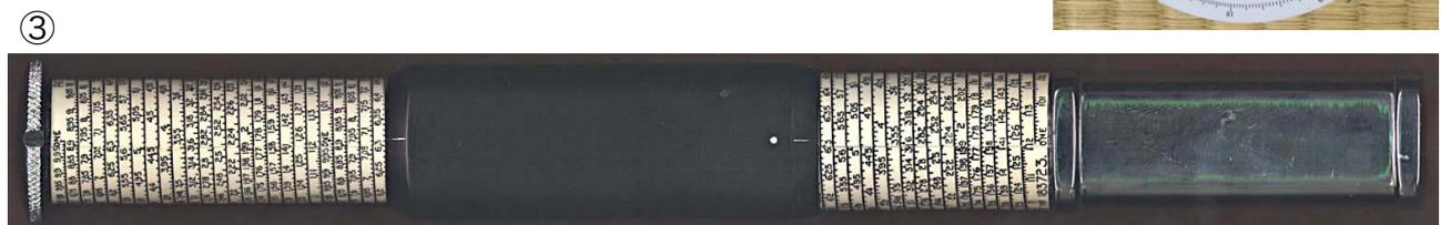
計算尺は長ければ長いほど精度がいいので、同じ大きさなら、目盛りを刻んだ長い尺をぐるぐる巻きにした円筒型がもっとも高精度にできます（長さが10倍になると精度が一桁増える）。しかし目盛りを読みにくく、読み間違いが増えるので、実用上は読みやすい直線型ばかりが使われました。しかし現在でも唯一、一般に製造販売されているのは円盤型だけです。円盤型は目はずれ（5ページ）がなく、また同じ精度なら円盤型の直径は直線型の長さの約1/3で済むので、コンパクトだからです。
